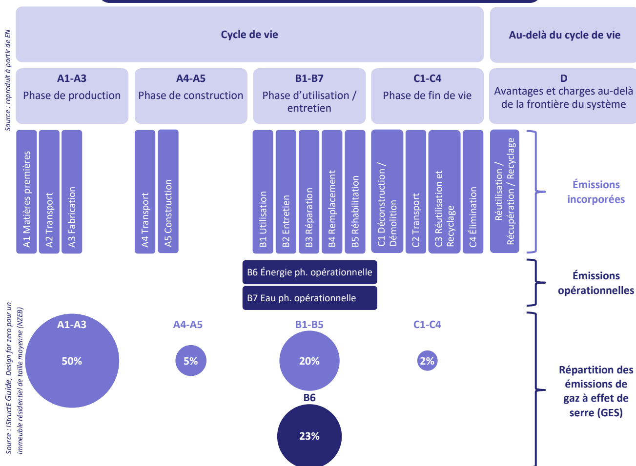
Graphique 1 : Phases du cycle de vie d'un bâtiment et répartition des émissions de GES
